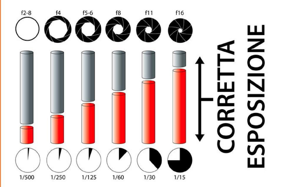
Modificando la quantità di luce che arriva al sensore: il diaframma ne muta l'intensità, l'otturatore ne varia il tempo.
